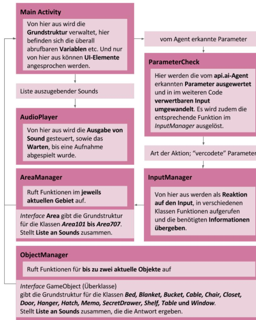
Abb. 25 Klassen, die in der Programmierung verwendet werden und deren Funktionen sowie Verbindungen untereinander. Nicht aufgelistet sind unter anderem Klassen für spezielle Datentypen.
